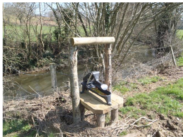
Pompe à museau réalisée sur le Vicoin à Port-Brillet
