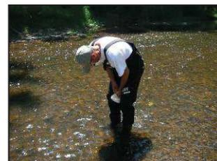
Le matériel benthique a été récupéré par broyage de substrats durs naturels, mis dans des piluliers, alcoolé *in situ*. Les récoltes ont été dûment étiquetées et apportées au laboratoire Bi-Eau à Angers qui est chargé de la détermination et de l'analyse de ces prélèvements.
